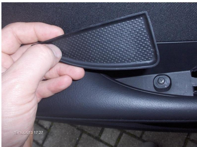
Dann mit dem "Spezialwerkzeug" den Block von unten nach oben-links rausgezogen.
